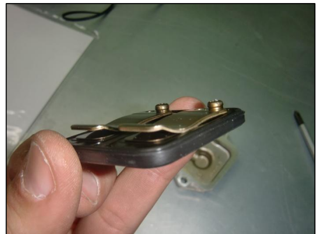
Detalle de los soportes volteados bloqueando el movimiento de las láminas
