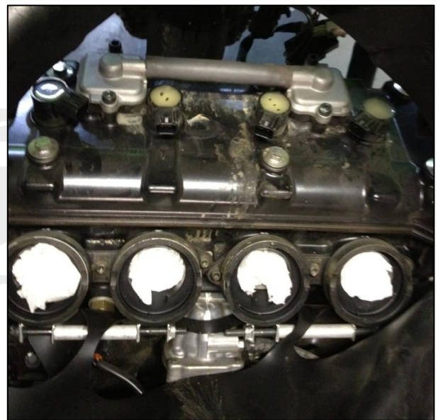
Tubo aislante para evitar la entrada de suciedad
