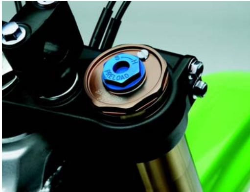
Regulador de precarga del muelle en la parte superior de la barra derecha
