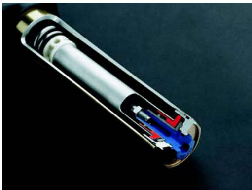
Detalle interno del regulador de precarga del muelle. En azul se observa el regulador, en rojo el casquillo que hace presión sobre el vástago de aluminio que precarga el muelle.
