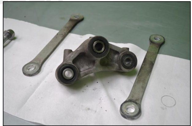
Detalle de un tope inferior con síntomas de degradación
